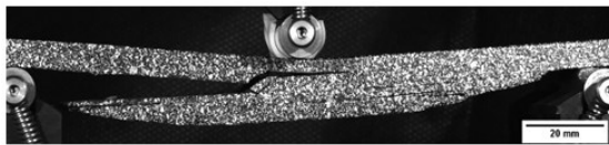
Figura 3 – Imagem da Fratura do corpo de prova obtido pelo sistema de aquisição de imagens do DIC.
