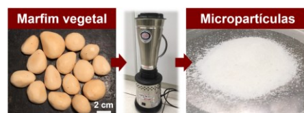
Figura 1 – Sementes de marfim vegetal (esquerda), liquidificador industrial (centro) e micropartículas após peneiramento (direita).
