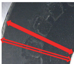
Figura 4 – Representação das diferentes regiões de medidas de rugosidade nos corpos de prova.
