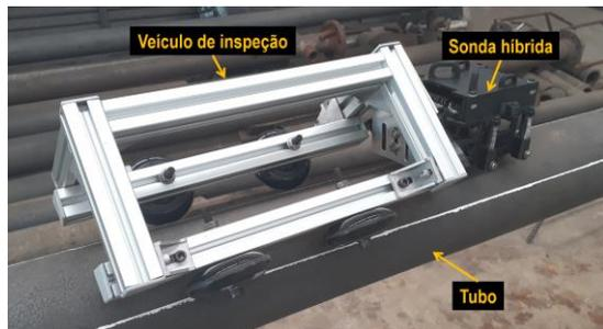
Figura 1 – Veículo de inspeção acoplado a sonda híbrida.
