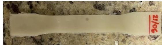
**Figura 2** – Corpo de prova com bolha.
