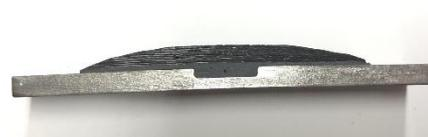
**Figura 1** – Imagem do corpo de prova antes do processo de envelhecimento
